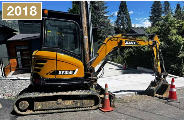
SANY SY35U Mini Hydraulic Excavator
